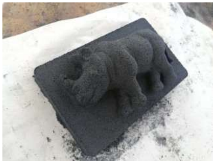
ภาพที่ 2 ถ่านไม้ไผ่อัดรูปแตรที่ผ่านกระบวนการอบไล่ความชื้น
