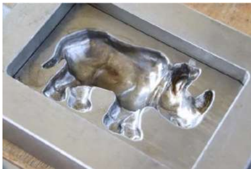
ภาพที่ 1 แม่พิมพ์รูปแรดสำหรับขึ้นรูปถ่านไม้ไฟ
